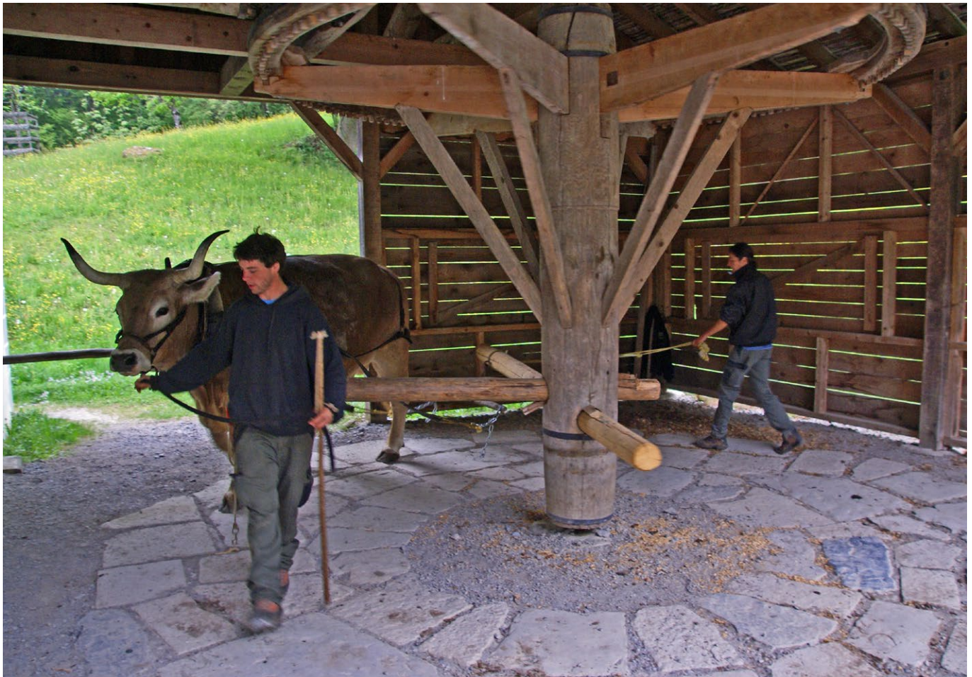
14 Freilichtmuseum der Schweiz, Göpel aus Ecoteaux, La Cergne: Der Göpel war bei seinem Abbau weitestgehend intakt, dennoch waren Restaurierungsarbeiten und Holzaustausch notwendig. Die Anlage kann in der Museumssaison in Betrieb genommen werden. Aufnahme 2011.
