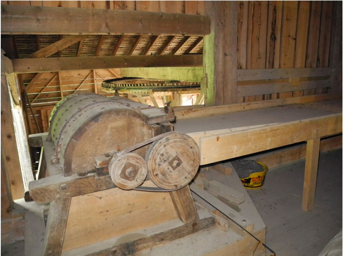
15 Freilichtmuseum der Schweiz, Göpel aus Ecoteaux, La Cergne/Bauernhaus aus Villars-Bramard: Mit dem aussenliegenden Göpel wird die Dreschmaschine im Ökonomieteil des Bauernhauses angetrieben. Aufnahme 2013.
